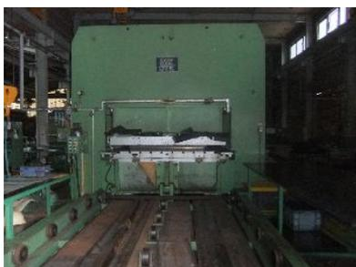
写真③ 3200t蒸気プレス
