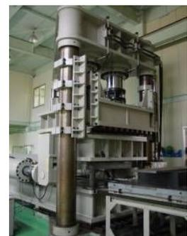
写真② 154MN二柱式試験機
